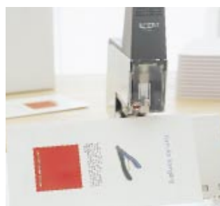
R106E voor zadelhechten. Instelbare papieraanleg zodat de nietjes exact geplaatst kunnen worden. Hechten met pedaal.
